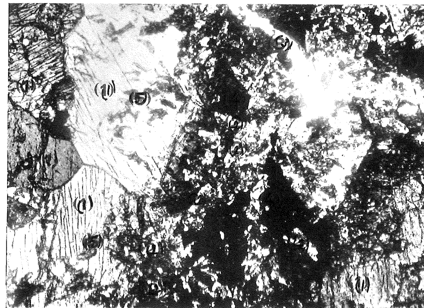
Foto 29.—Microfotografía de la diabasa ofítica del valle de Arraya. (1). Augita en grandes cristales.—(2). Cristales de feldespato alargado, tipo labrador.—(3). Veta de cuarzo.—(4). Magnetita.—(5). Clorita.
